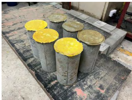
รูปที่ 2-1 คอนกรีต (Cylinder) ขนาด 15 x 30 เซนติเมตร
