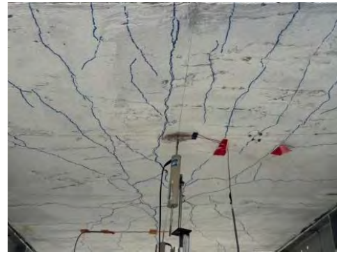
รูปที่ 4-98 ความเสียหายที่เกิดขึ้นบริเวณด้านล่างพื้นสะพานจำลองที่ก่อสร้างด้วยคอนกรีตปกติ แผ่นที่ 1 (ST-NC20-1)
