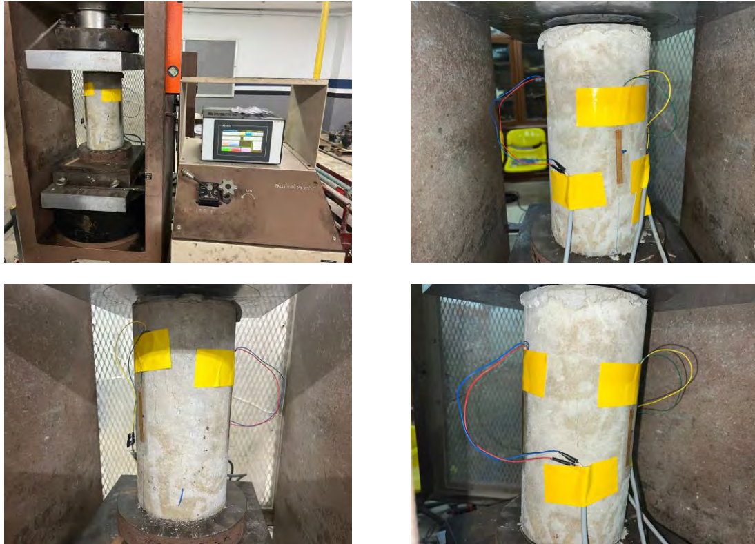
รูปที่ 2-3 การทดสอบกำลังรับแรงอัด
