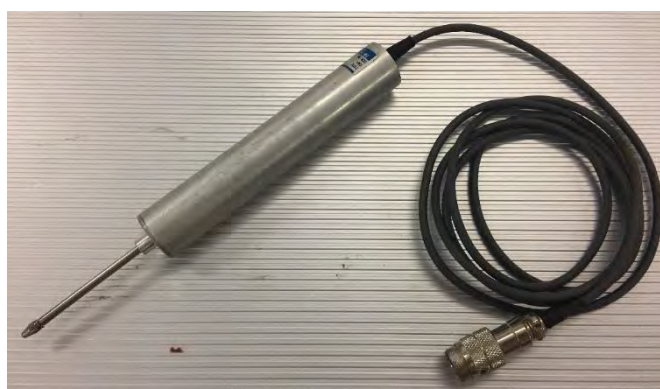
รูปที่ 3-2 อุปกรณ์ตรวจวัดการเสียรูปของโครงสร้าง
