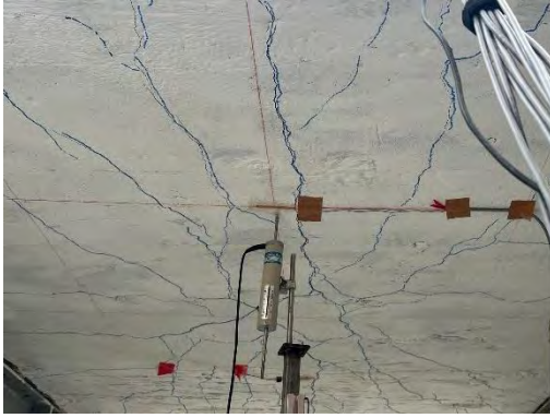
รูปที่ 4-2 รายละเอียดการแตกร้าวของพื้นสะพานจำลอง (ST-NC20-1)
