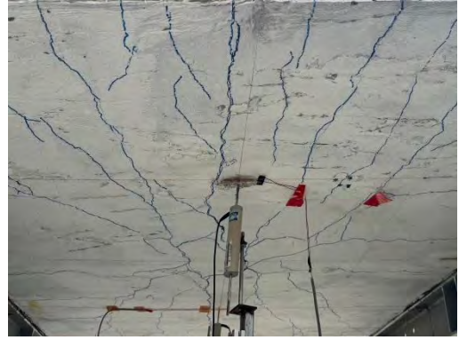
รูปที่ 4-2 รายละเอียดการแตกร้าวของพื้นสะพานจำลอง (ST-NC20-1)
